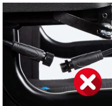
Si la batería se instala incorrectamente o si la conexión no es correcta, la silla iTrion no funcionará y dará una alerta de error.
