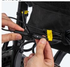
El conector del controlador es un conector impermeable de seis núcleos M12, vea las flechas en la figura a continuación, alinee las flechas en los conectores en ambos extremos, insértelo y apriete la tuerca.
