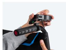
Deslice la muesca del controlador en el mango y deslice con la almohadilla para el pulgar colocada en el interior como se muestra.
