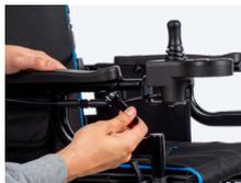
Vuelva a colocar el soporte del controlador en el lado izquierdo y ajuste los tornillos.
