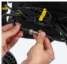
Para conectar el controlador trasero al conductor, localice el puerto de conexión en el controlador trasero y el cable de alimentación que se encuentra debajo del asiento. Utilice el cable etiquetado como 'rear controller'. Conecte los puertos macho y hembra y asegúrese de que estén firmemente unidos.
